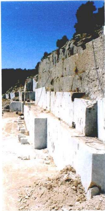
Fotografías 4.1. y 4.2. Contraste entre el aspecto final de las caras de talud de banco terminadas con barrenos (partes altas de los frentes) y con hilo (partes bajas), en dos canteras de la Sierra de Burete y de la Sierra de Cabras, respectivamente.
